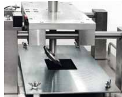
Dispositivo para la prueba del tacón. Prueba de fuerza de los elementos de fijación.
