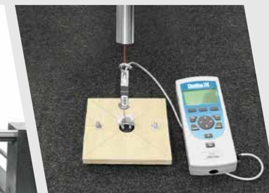
Prueba de resistencia de los elementos de fijación
