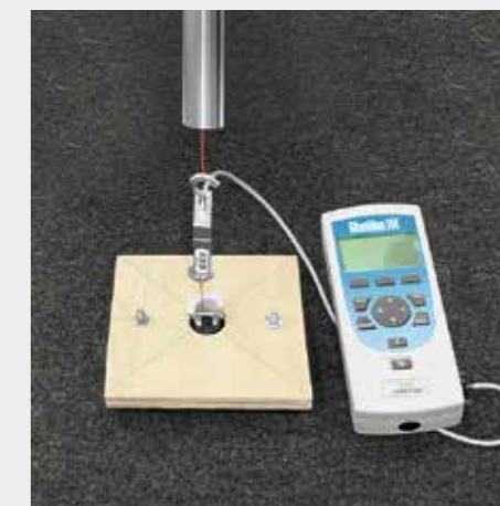
Comprobación de la fuerza del elemento de fijación.
