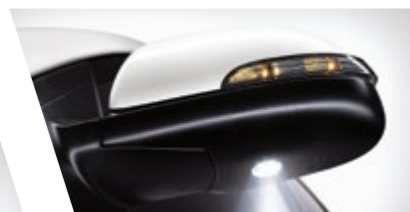
Retrovisores con luz de cortesía e intermitentes LED integrados
