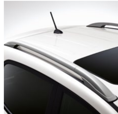
Rieles en techo
