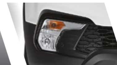
Faro antiniebla delantero con intermitente integrado
