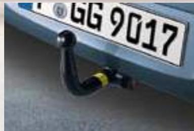
**Enganche para remolque desmontable.** Creado a medida para una perfecta instalación. Consulta con tu Distribuidor y/o Reparador Autorizado para conocer la masa máxima remolcable, variable según la motorización (Masa máxima remolcable hasta 1.300 kg). La conexión eléctrica debe solicitarse por separado.
