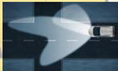
**Iluminación Lateral Estática.** Al accionar el intermitente circulando a baja velocidad, ilumina un área lateral de 90° en la zona de intersección.
