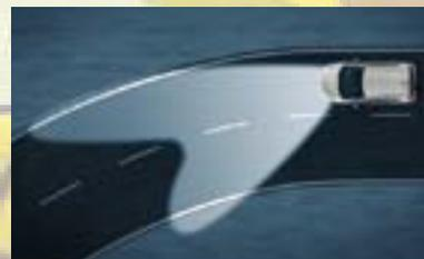
**Iluminación Dinámica en Curvas.** En función del ángulo del volante y la velocidad del vehículo, los faros AFL giran hasta 15° para iluminar el trazado de la curva.
