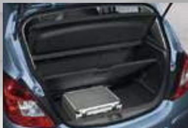
**Suelo del maletero ajustable en dos alturas.** Para formar una superficie plana con el asiento trasero plegado, y a la vez disponer de un compartimento inferior. O contar con la máxima altura de carga.
