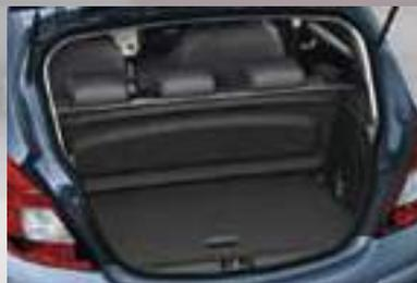
**Bandeja trasera.** Cuando es necesaria la máxima altura de carga, la bandeja cubremaletero dispone de un soporte detrás del asiento trasero.
