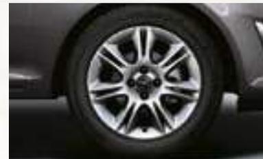
Llantas de aleación 6 x 16, diseño de 7 radios dobles (QV4).
