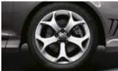
Llantas de aleación OPC 7 x 17, diseño de 5 radios en Y (PNJ).
