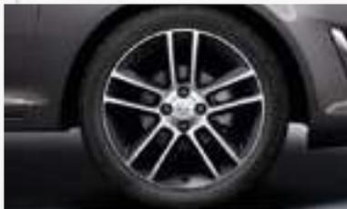
Llantas de aleación 7 x 17, diseño de 5 radios dobles, acabado Negro Brillante con perfiles tono Diamante.(QV3 & 77P).
