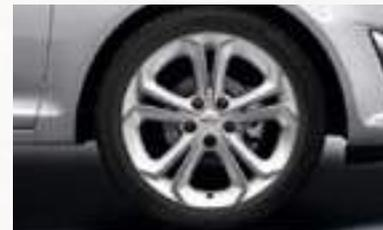
Llantas de aleación 7 x 17, diseño de 5 radios dobles, acabado Blanco pulido. (PNM & 65Q).
